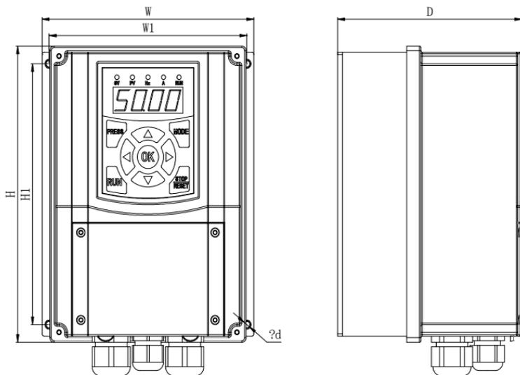
图 7-1 变频器尺寸示意图
