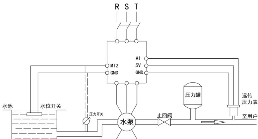
图 5-6 单泵控制示意图
