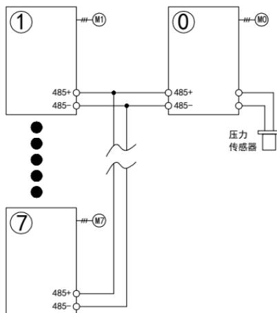
图 5-8 主从多泵控制示意图
