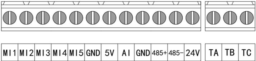
图 3-3 控制电路端子
