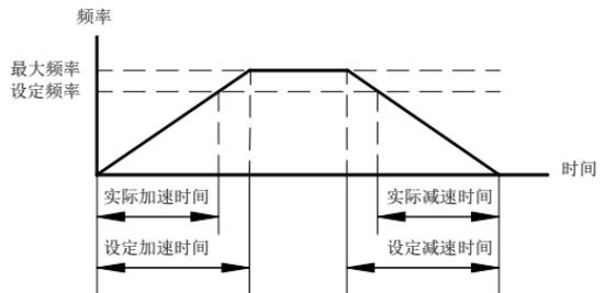
图 5-3 加减速时间示意图
