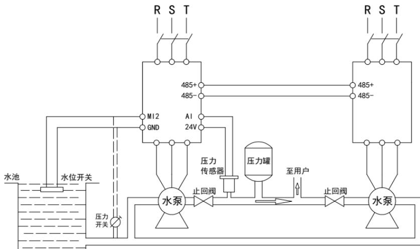
图 5-7 主从泵控制示意图
