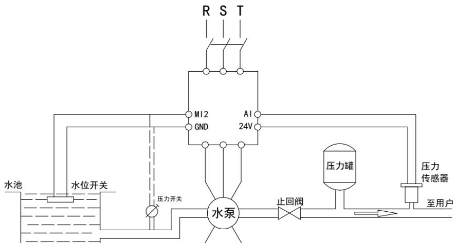
图 5-5 单泵控制示意图
